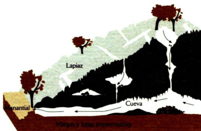
Figura 4: Esquema del modelado kárstico, donde se reconocen estructuras superficiales y una compleja red de galerías subterráneas. Dicho modelado ocurre mediante la disolución de la caliza por agua dulce acidificada tras el paso a través del suelo vegetal. Las flechas indican el sentido de infiltración y circulación de las aguas meteóricas. La salida al exterior del agua infiltrada tiene lugar en el contacto de la caliza con rocas impermeables infrayacentes.
